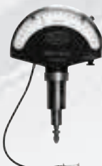
Прецизионный щуп Millitess, сконструированный в 1937 году. Первый индикаторный прибор для измерения отклонения от заданных размеров с ценой деления 1/1000 мм
