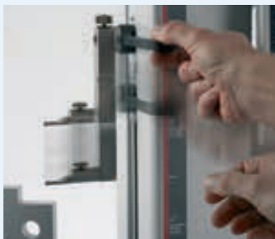
Рис. 1. Переместите измерительную каретку в направлении измеряемого объекта.
