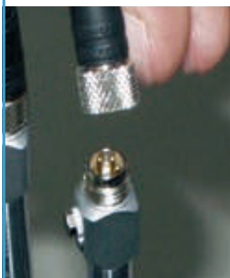
Возможность расстыковки кабеля и щупа.
