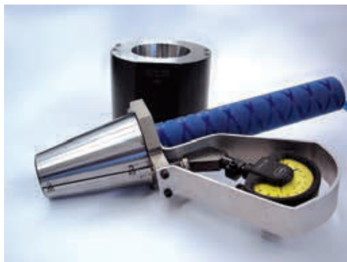
Коническое сопло-измерительное кольцо с коническим приспособлением
