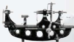
Измерительная машина, 1908 год. Отсчет по нониусу 1/10000 мм
