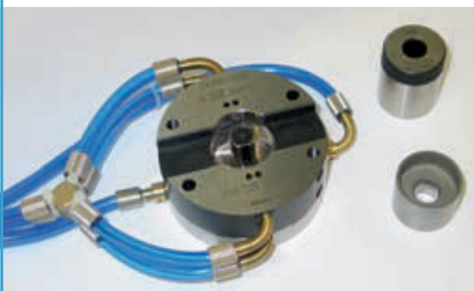
Пневматическое комбинированное измерительное устройство
