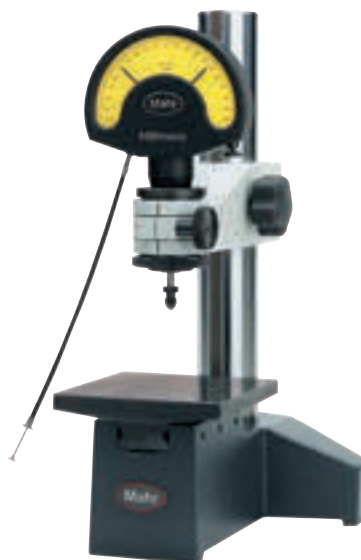
Прецизионная стойка 824 GT для приборов Millimess Large Type. Тонкая установка осуществляется за счет вертикального перемещения соединительной муфты
