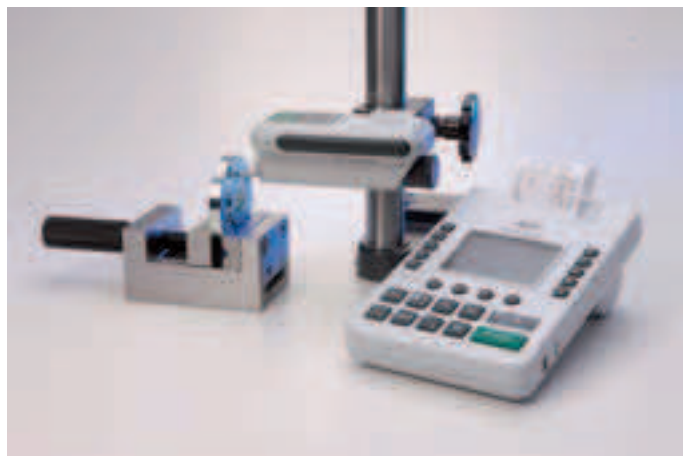
Измерение шероховатости на несущей поверхности (предприятие Airbus)
