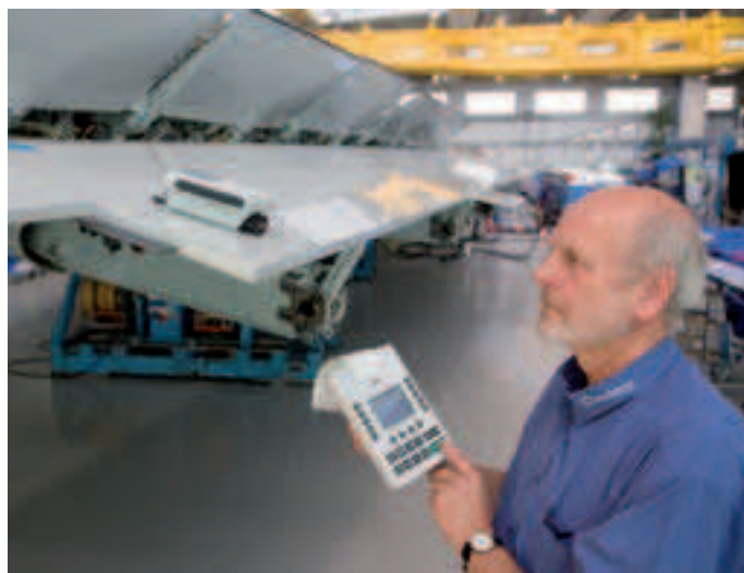
Измерение шероховатости на несущей поверхности (предприятие Airbus)
