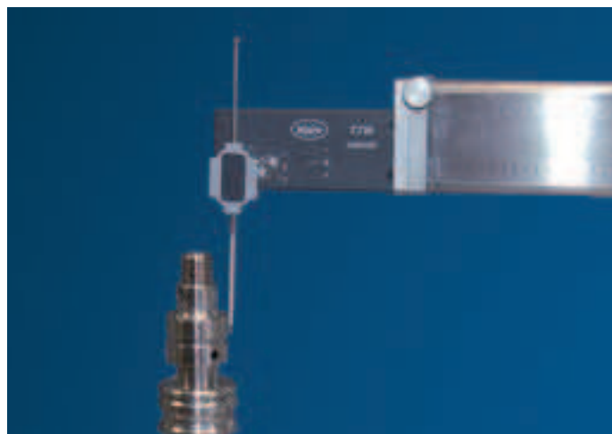
T7W со щупом для измерения шероховатости
